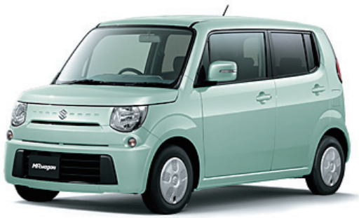
写真2 ユニハイテン®の適用事例（ドアパネル） Photo 2 Application of UNI HITEN® to door panel
